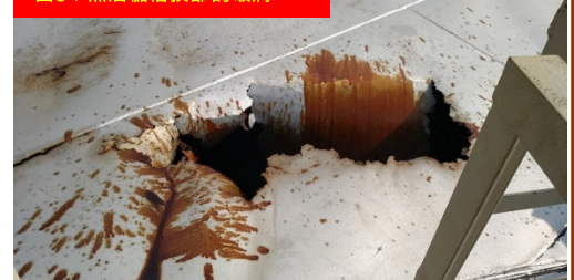
圖3：熱油儲槽頂部的破洞
