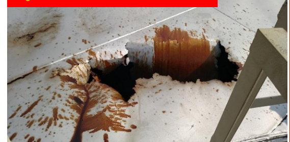
Fig. 3: Gat in het dak van de hete olie tank
