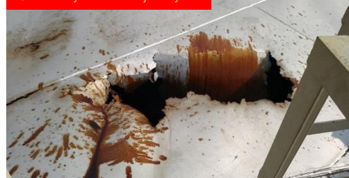
3. ábra: Lyuk a forró olaj tartályon
