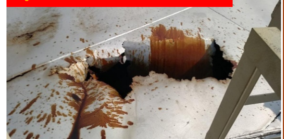
Fig. 3 : Trou dans le toit du réservoir d'huile chaude
