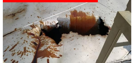
شکل ۳: سوراخ در قسمت فوقانی مخزن روغن داغ
